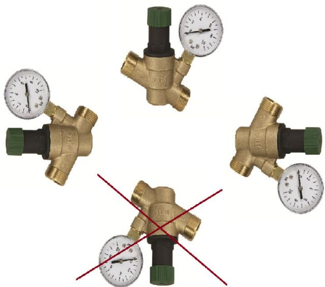
Редуктор может монтироваться в монтажном положении согласно изображения, при этом направление потока должно совпадать с направлением стрелки на корпусе редуктора. Запрещается монтаж полимерной крышкой вниз.
